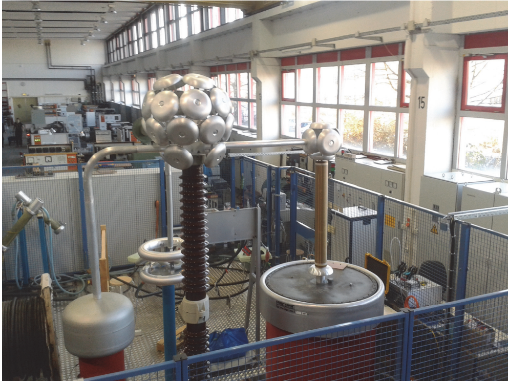
Wechselspannungs-Prüfsystem zur Erzeugung von Wechselspannungen bis 200 kV
